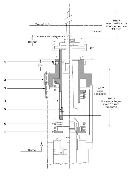
Fig. 1: Positioner P.S.E.O 62-404 Gr. 9
