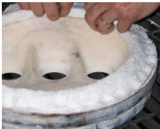
La empaquetadura blanda se coloca sobre la placa de orificio, mientras que la empaquetadura rígida se coloca por encima y entra en contacto con la boquilla de descarga.
