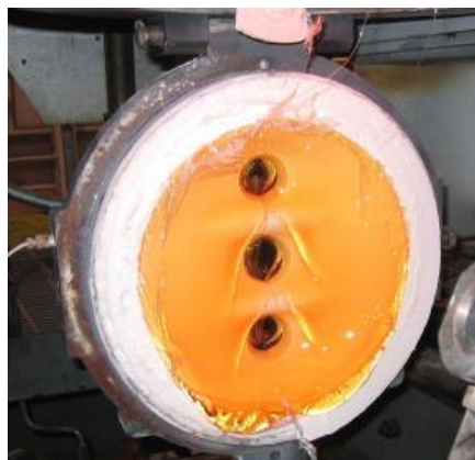
Esta empaquetadura brinda un sello adecuado sin pérdidas. El residuo de empaquetadura restante se limpia fácilmente de la parte inferior de la boquilla de descarga.
