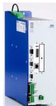
Con **FlexIS 3** el controlador utiliza la tecnología de control de movimiento y transfiere el punto de ajuste cada 2 a 4 ms.
